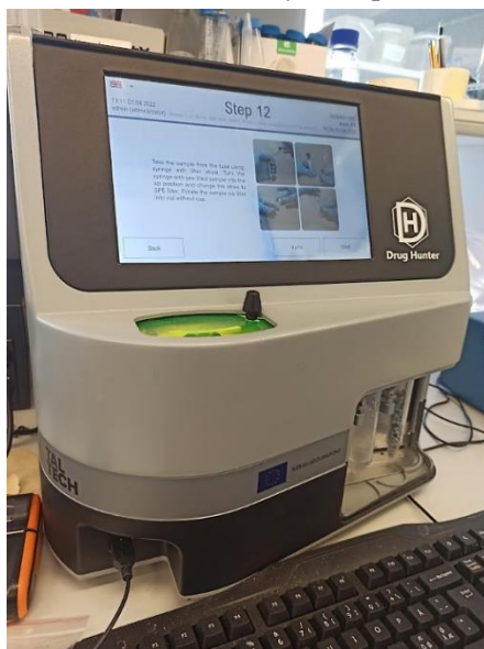
Rysunek 5. Aparatura Drug Hunter Analyzer opracowana przez naukowców z TalTech , Estonia [źródło: własne]
